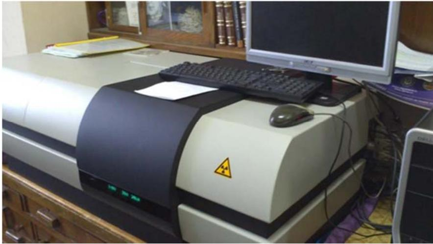
Рисунок 10 – Микрокомпьютерный томограф фирмы Sky-Scan
