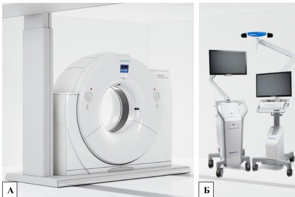
Рисунок 3.38 – Интраоперационный спиральный компьютерный томограф (А) и система навигации (Б)
