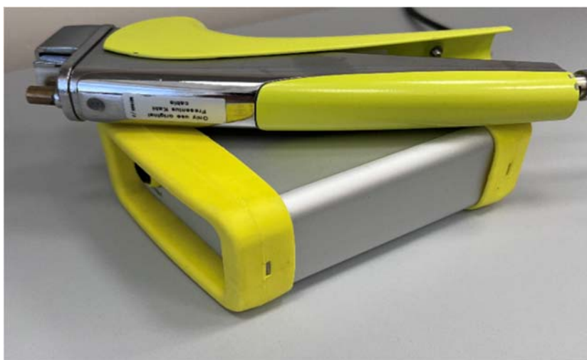
Рисунок Б3 - Диэлектрический запаиватель магистралей для предотвращения разгерметизации контура
