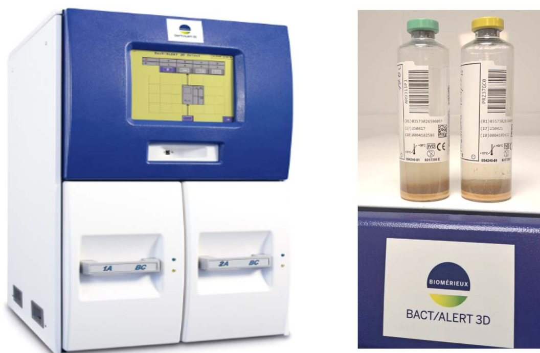
Рисунок 15 - Оборудование для микробиологического исследования. Слева – автоматический бактериологический анализатор BacT/ALERT 3D, BioMérieux, США. Справа – флаконы с питательными средами и адсорбентами (зеленая крышка – для анаэробов, желтая – для аэробов)
